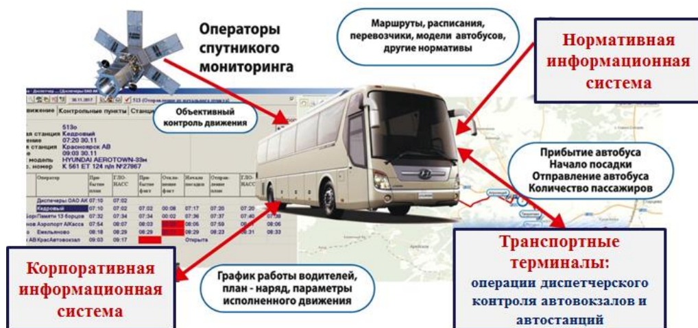
Рис. 13. Функциональная схема системы диспетчерского управления BusTraffic-Control
